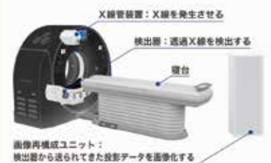
図2 CT装置の模式図
